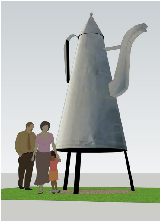
Krug aus Zinkblech mit Beinen aus Stahl: Höhe 4.7 Meter, Durchmesser 2.4 Meter, unterer Rand zirka 1 Meter.
